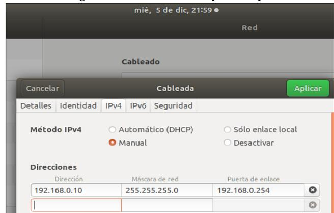
Fig. 63 Configuración de red en estación de trabajo Ubuntu
