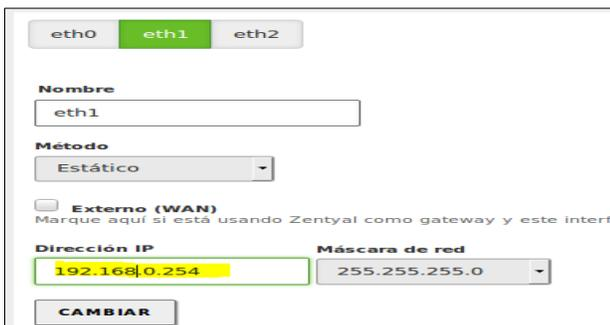
Fig. 60 Configuración interface LAN
