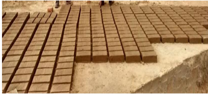
Figura 17: Reposo-Presecado. Fuente: Los autores (2018)
