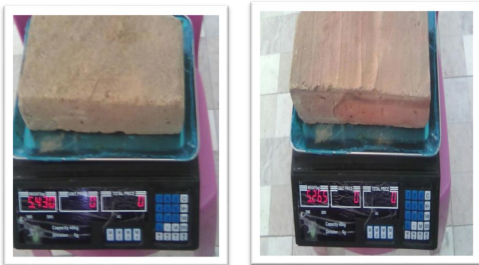
Figura 23: Ladrillo en etapa de presecado y cocido. Fuente: los autores (2018)
