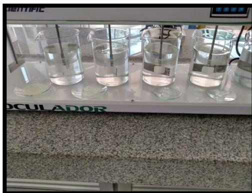
*Ilustración 11 Floculador para Test de Jarras
