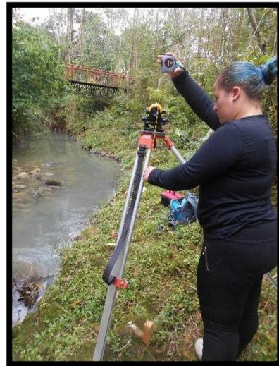
*Ilustración 19 Instalación y Calibración de Equipo de Topografía
