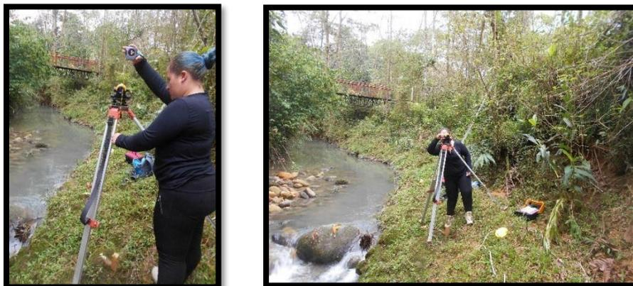
*Ilustración 4 Nivelación de Equipo de topografía
