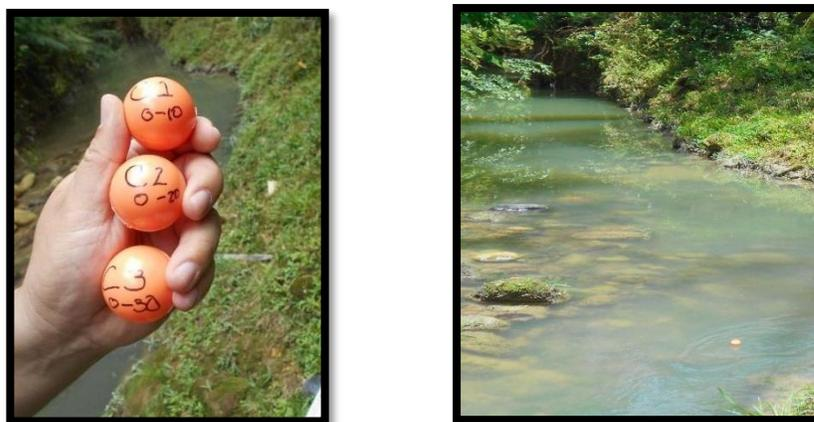
*Ilustración 7 Pimpones para Medición de Caudal*
