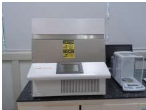
Figura 17. Instrumento termogravimétrico para el análisis próximo de carbones (foto del autor).
