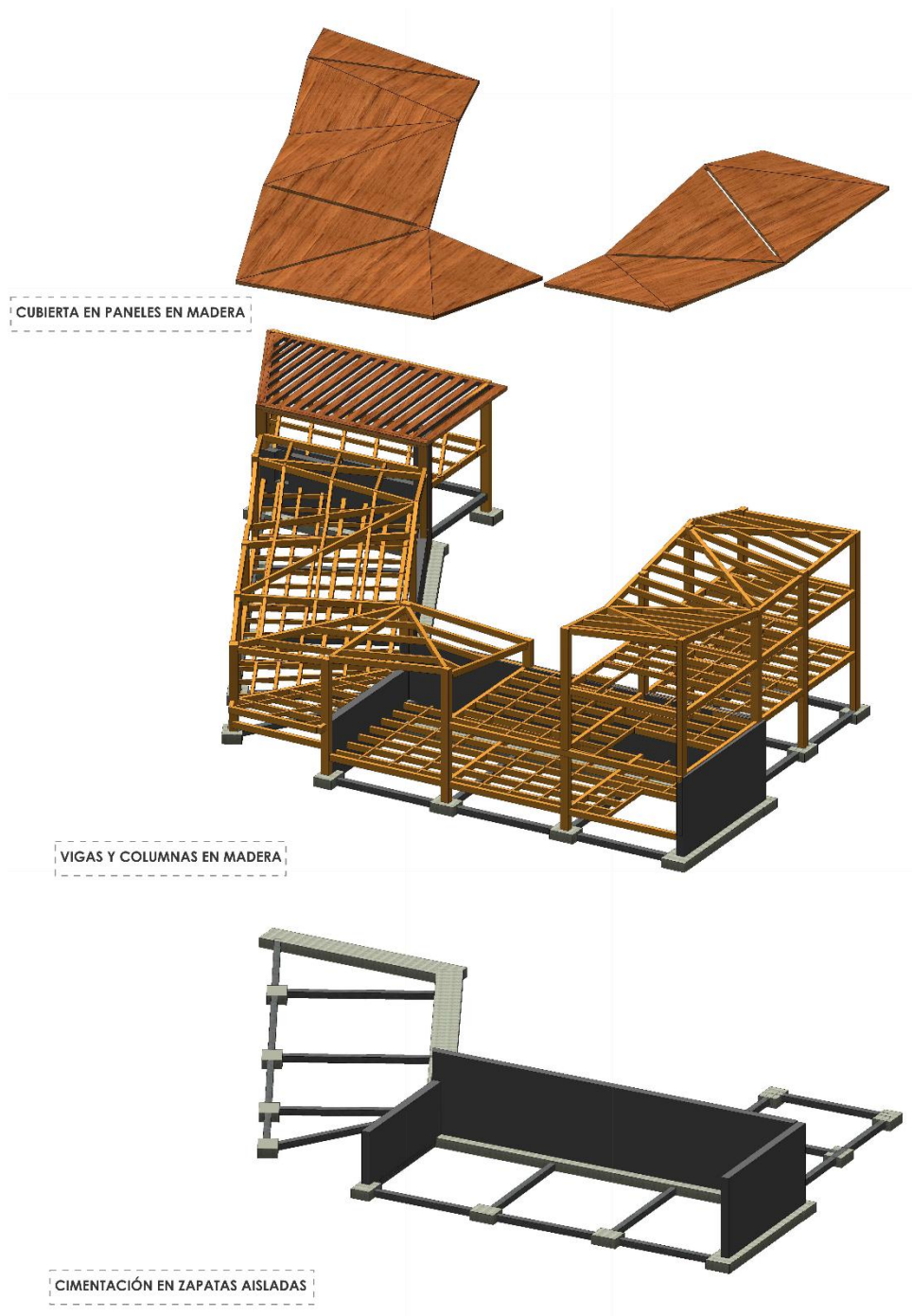
Figura N26: Axonetría sistema estructural.
