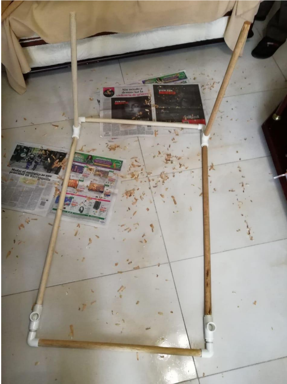
Figura 55. Base fabricada para el invernadero.
