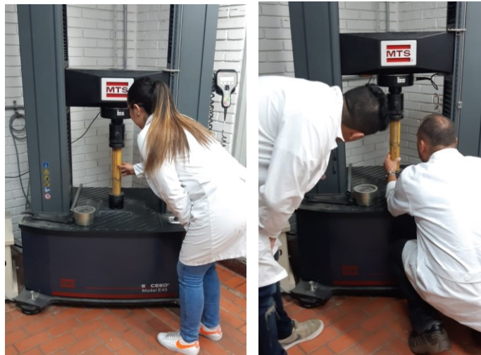
Imagen 25 Fotografías ensayo de Compresión de la Guadua, Laboratorio de la Universidad Católica de Colombia
