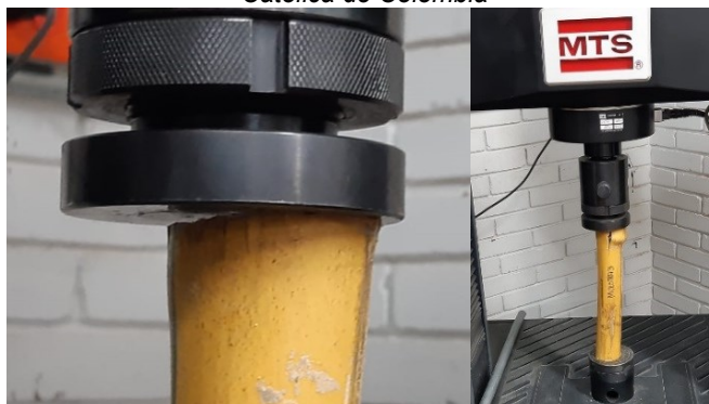
Imagen 26 Fotografías rotura de la muestra 3 en ensayo de Compresión, Laboratorio de la Universidad Católica de Colombia
