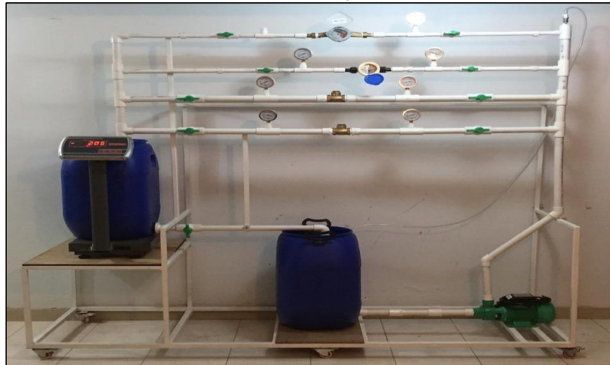
Ilustración 31. Estructura terminada para la realización de aforos.
