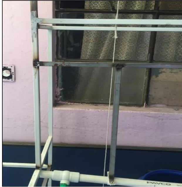
Ilustración 28. Superficie de soporte para tanque de 60 Litros.
