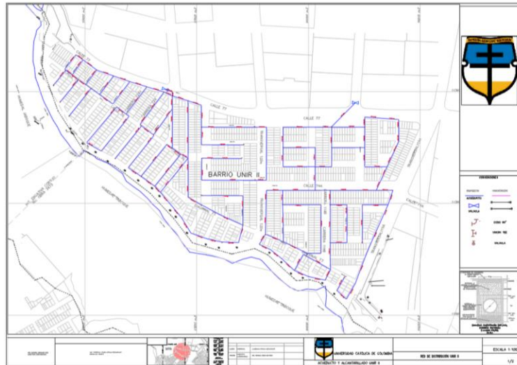
Ilustración 22. Red de Distribución de Agua Potable Propuesta
