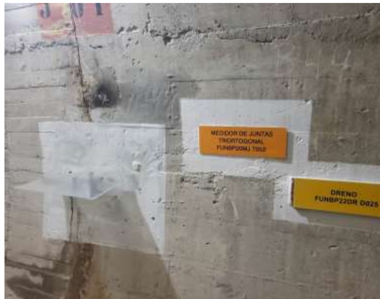
Figura 15 Medidores de dilatación zona inferior central hidroeléctrica.
