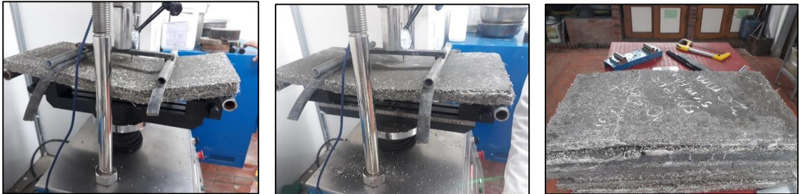
Figura 59. Falla presentada en las láminas de fibras recicladas
