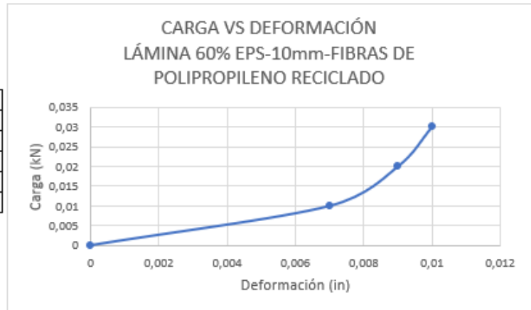
Figura 107. Carga vs Deformación – lámina fibras recicladas – 60% EPS
