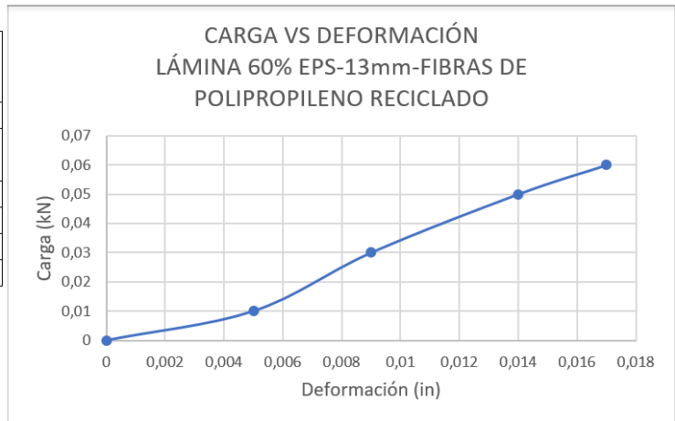
Figura 100. Carga vs Deformación – lámina fibras recicladas – 60% EPS
