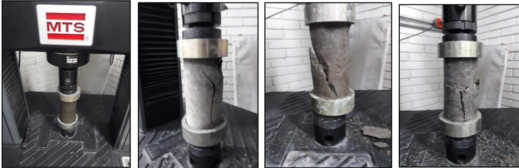
Figura 77. Tipo de falla a compresión en las probetas
