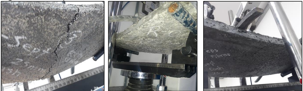
Figura 60. Falla presentada en las láminas de fibras refinadas
