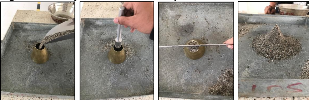
Figura 66. Ensayo cono humedad superficial
