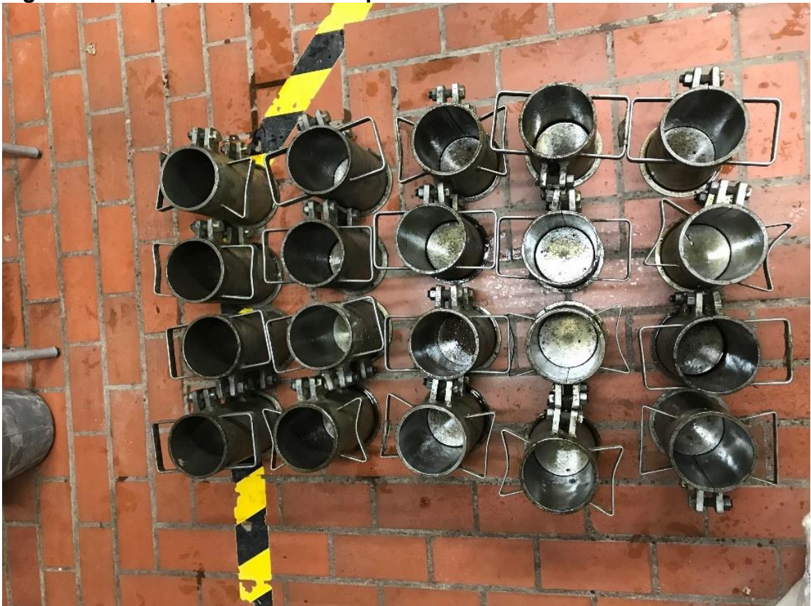
Figura 72. Preparación de moldes para fundición
