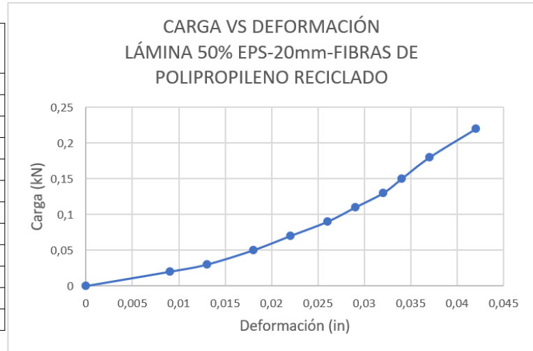
Figura 94. Carga vs Deformación – lámina fibras recicladas – 50% EPS
