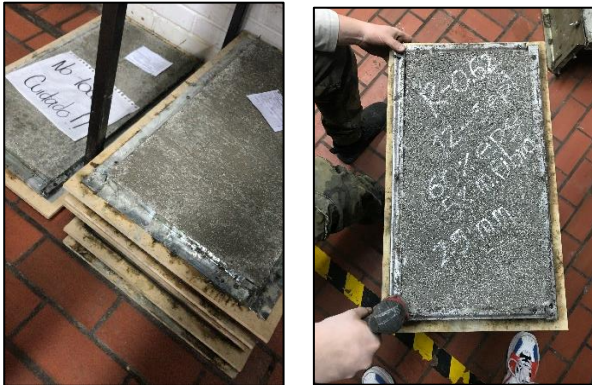
Figura 81. Proceso de desencofrado
