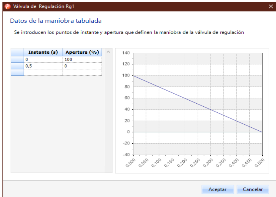
Figura 35. Apertura de las válvulas de regulación
