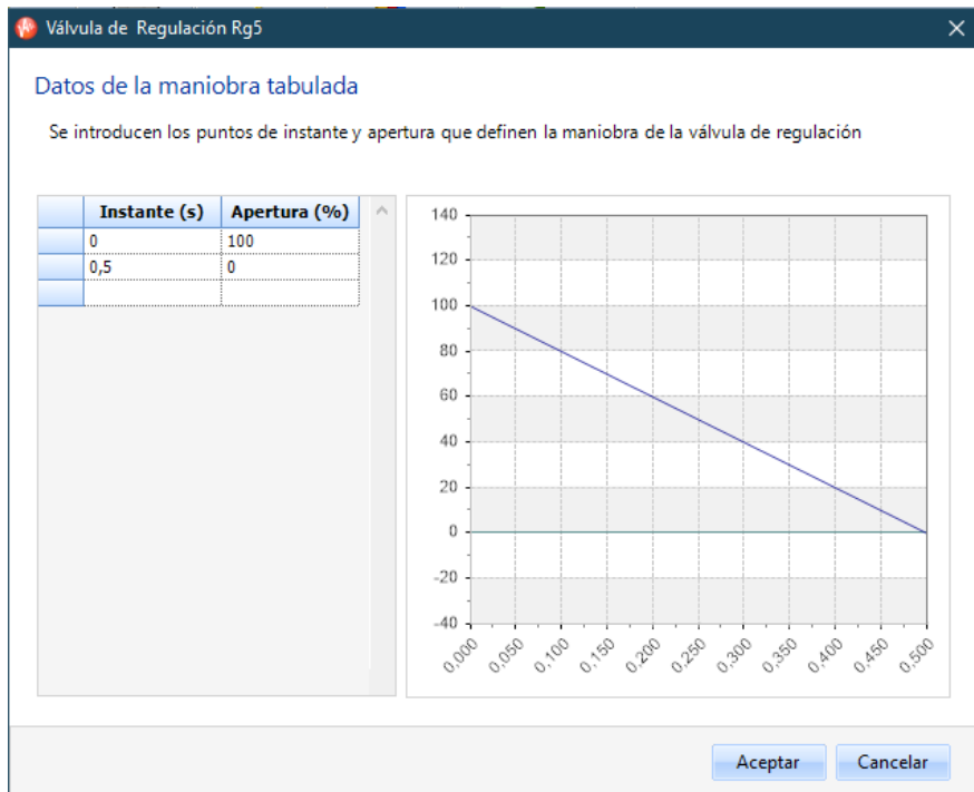
Figura 26. Apertura de las válvulas de regulación
