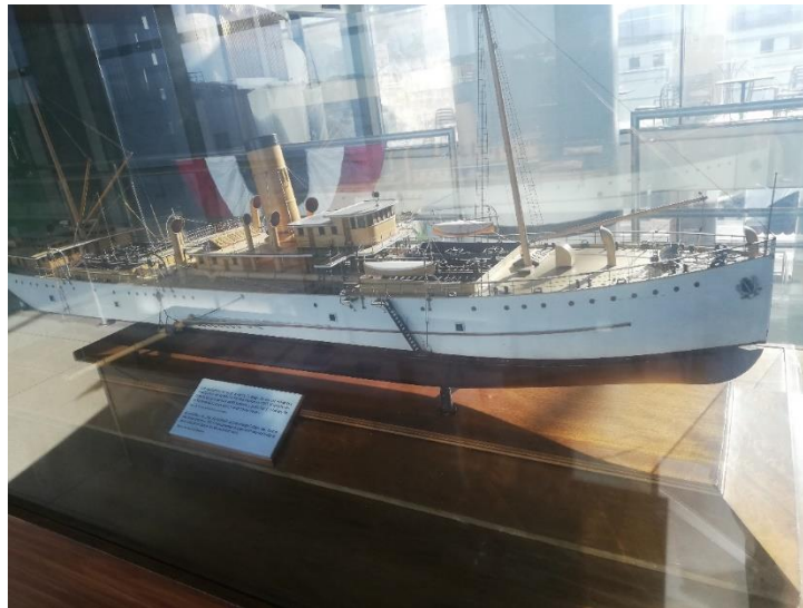
Ilustración 36. Draga de succión hidráulica Culebra- Museo ubicado en esclusas Miraflores Canal Panamá
