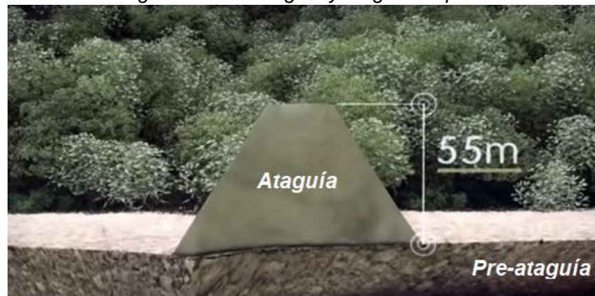
Figura 27. Pre-ataguía y ataguía en perfil
