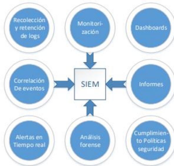
Figura 5. Arquitectura de los sistemas SIEM 12 . Tomada de: http://openaccess.uoc.edu/webapps/o2/bitstream/10609/81267/6/ljasomarTFM0618memoria.pdf
