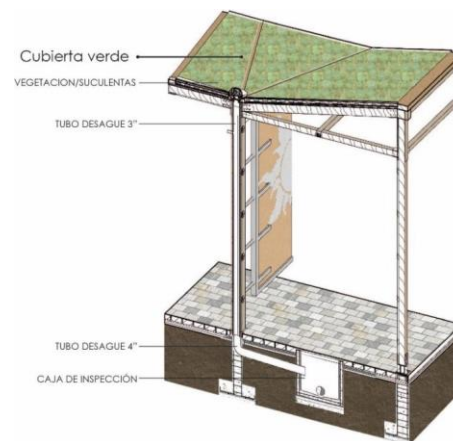
Figura 36: Cubierta verde Elaboración Propia
