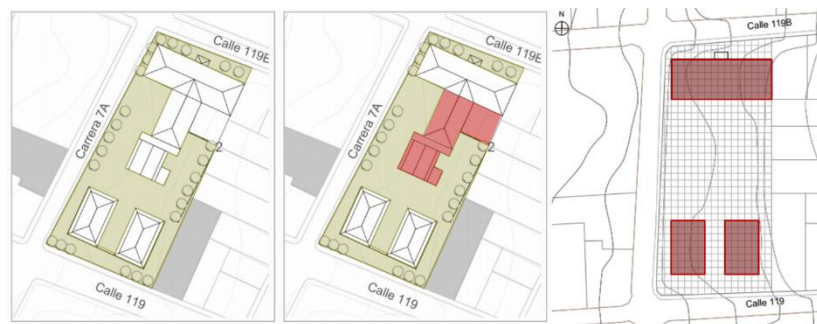
Figura 24. Proceso de liberación y demolición del Bien de interés cultural.
