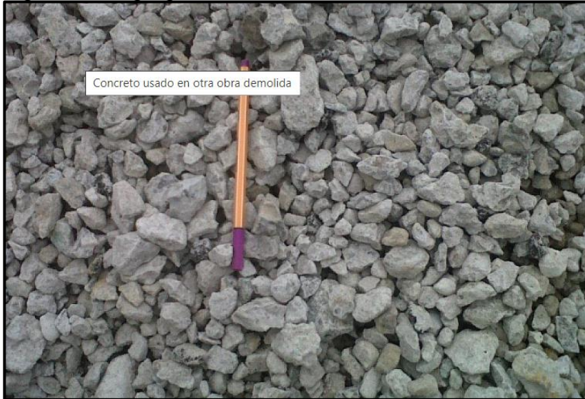
Figura 24 . Agregados de concreto reciclado ACR
