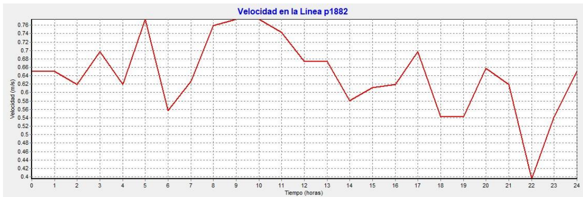
ILUSTRACION 6-57 Grafico de velocidades de la tubería 1882 la cual une el nodo 853 y 854 del modelo hidráulico de Funza Cundinamarca, dicha tubería se encuentra al inicio del sector de casco urbano 2.
