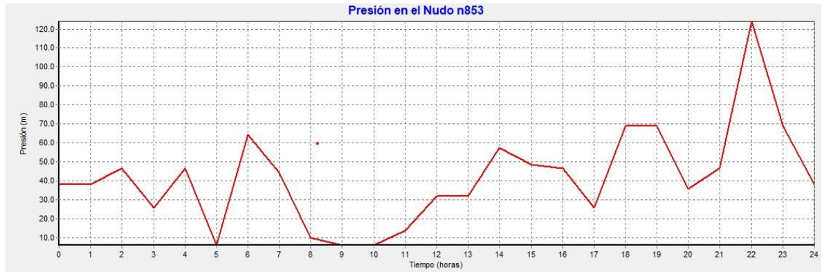
ILUSTRACION 6-55 Grafico de presiones en el nodo 853 del modelo hidráulico de Funza Cundinamarca, dicho nodo se encuentra al inicio del sector Casco urbano 2
