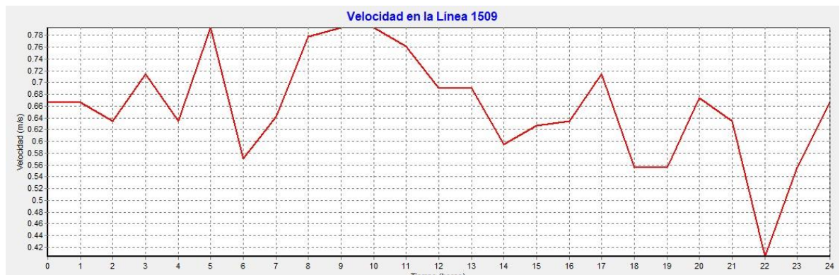
ILUSTRACION 6-54 Grafico de velocidades de la tubería 1509 la cual une el nodo 710 y 712 del modelo hidráulico de Funza Cundinamarca, dicha tubería se encuentra al inicio del sector de casco urbano 1.
