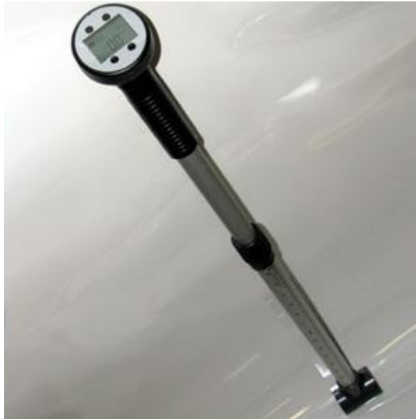
Figura 24. Correntómetro o molinete
