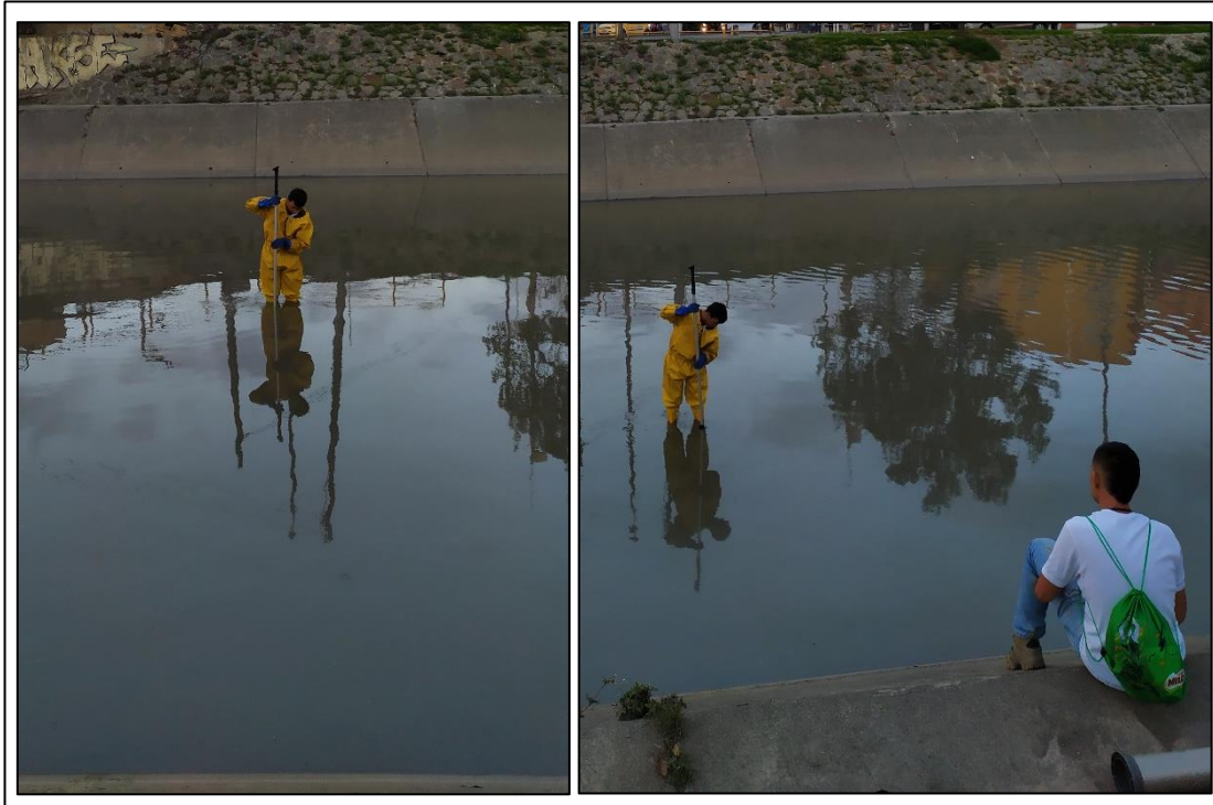
Figura 25 Aforo del canal río Salitre con correntómetro
