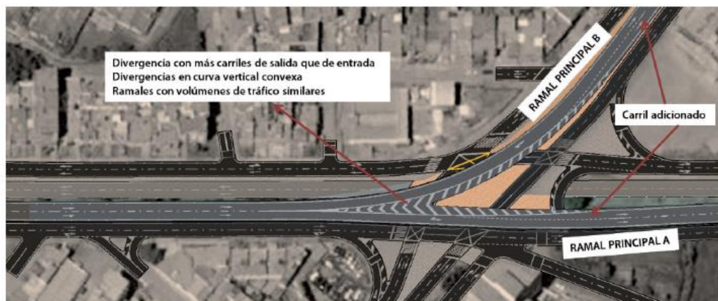
Figura 31. Divergencia tipo 6 en curva vertical convexa
