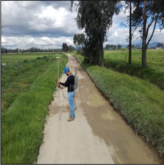
Figura 10. Registro de datos en el GPS Rover vía ICA.
