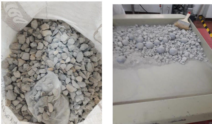
Imagen 2-2 Preparación de la muestra de RCD en máquina de los ángeles.
