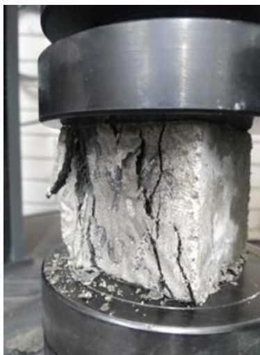
Imagen 4-1 Ensayo de compresión.
