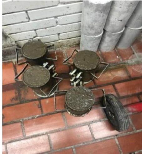
Imagen 3-3 Cilindros de mortero.
