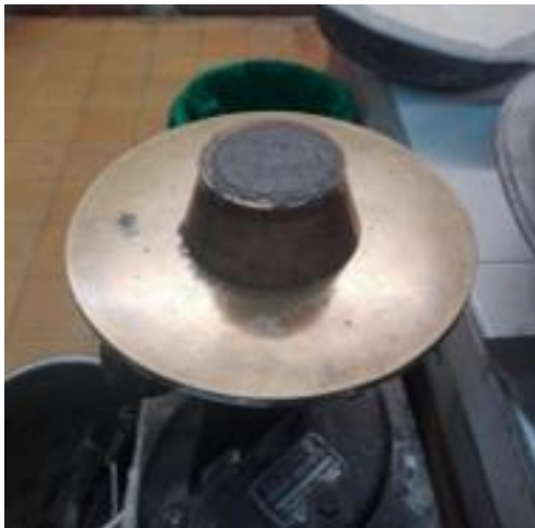
Imagen 3-1 Determinación de la fluidez del mortero.
