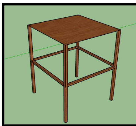
Figura 36 Base del tanque en madera
