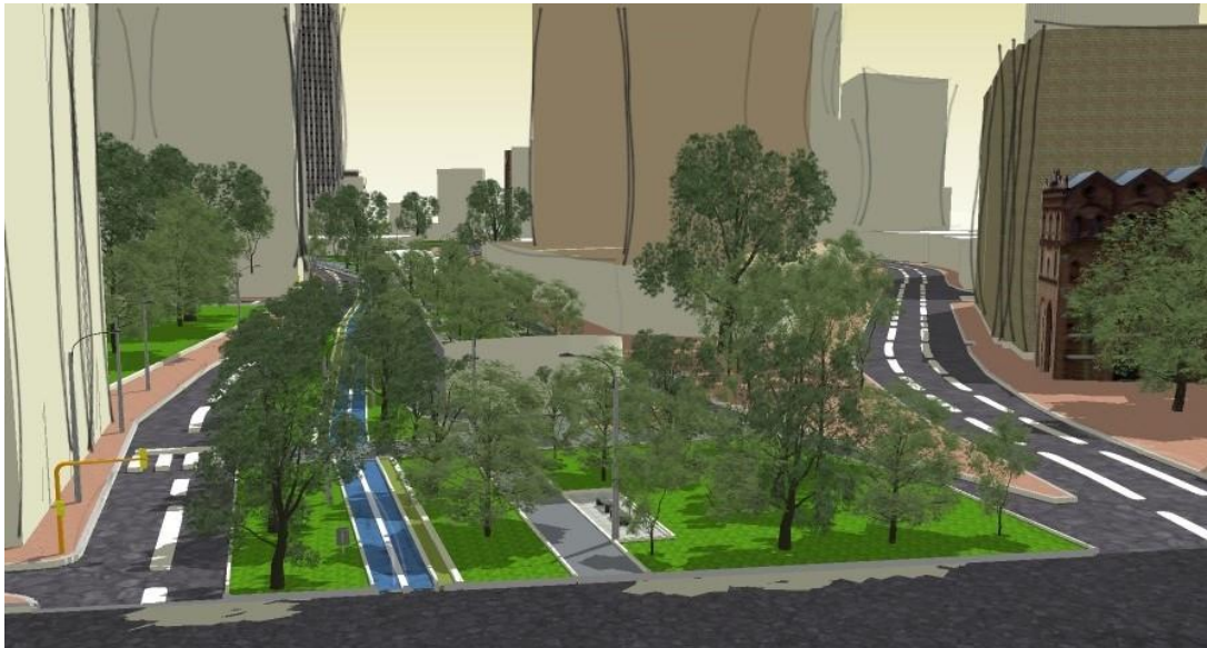
Gráfico 71. Esquema de segregación de tránsito por actor vial (caso de estudio). Fuente: Elaboración propia. (2019)
