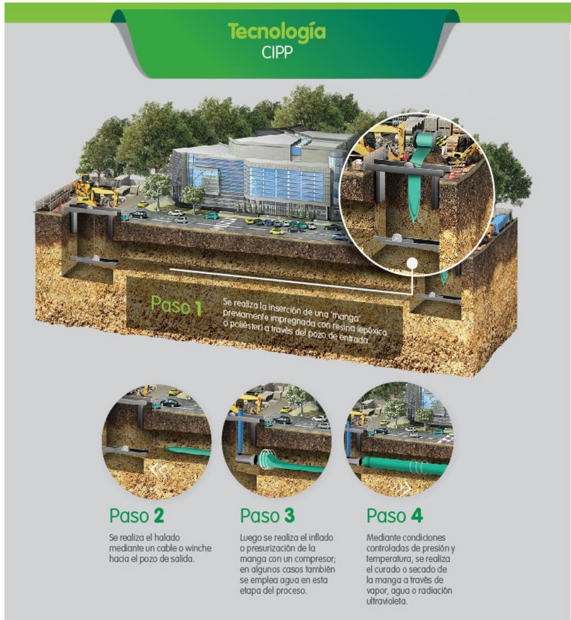
Figura 4. Procedimiento Tecnología CIPP.
