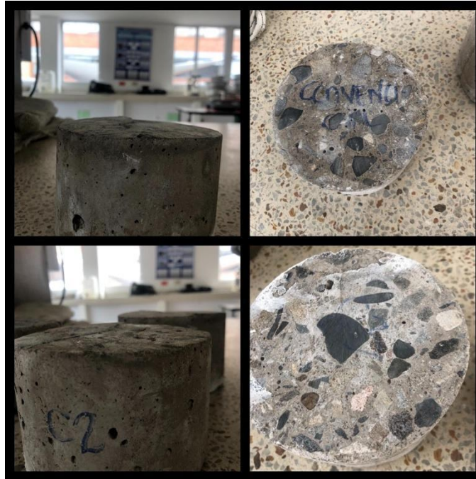
Figura 23. Cilindros expuestos a sulfato de magnesio
