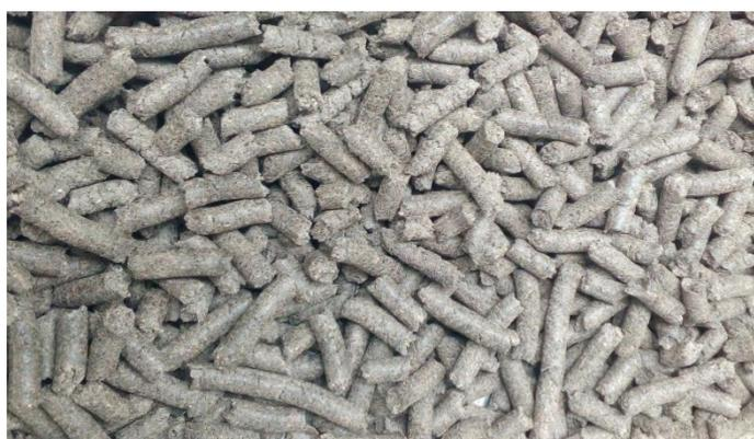
**Figura 10.-** Pellets obtenidos tras la extracción con prensa.
