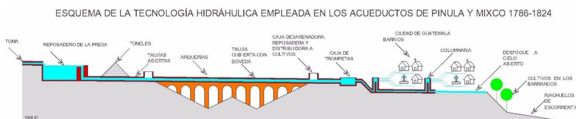
Imagen 67. Esquema de la tecnología hidráulica empleada en los acueductos de Pinula y Mixco 1786-1824. Elaboración propia. 1313
