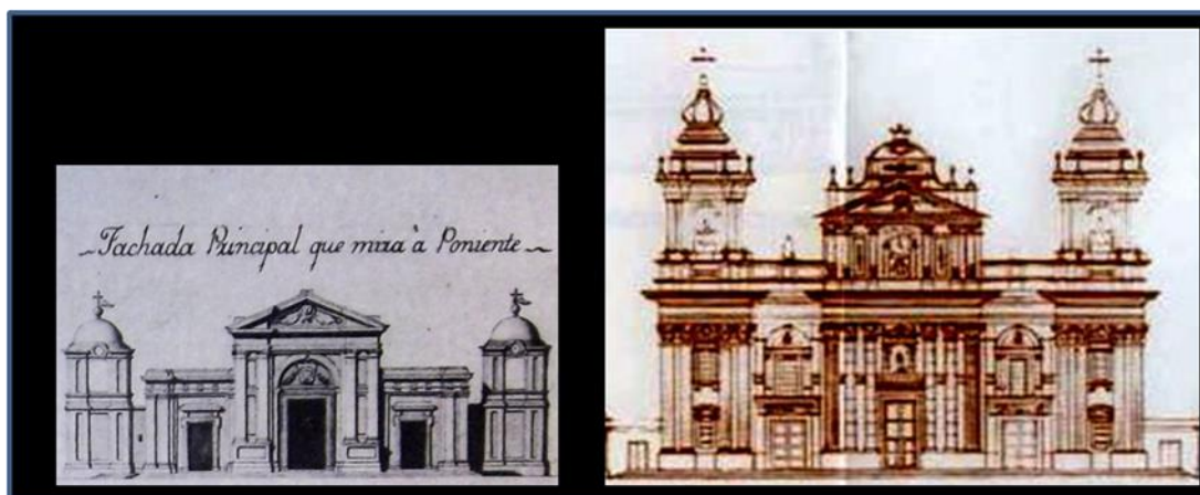
Imagen 142. Comparación de las proporciones volumétricas planteadas para la fachada de la catedral, entre la propuesta de 1782 y el resultado final, posterior a 1815. 2351
