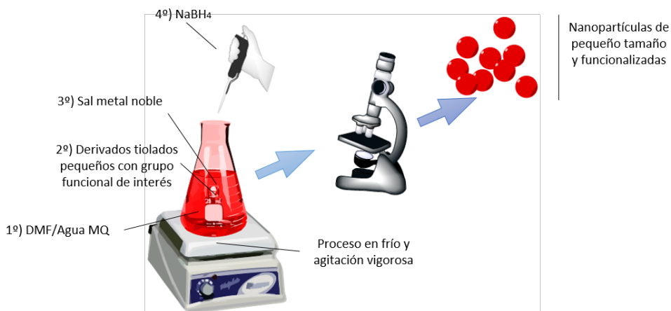
Figura 14. Metodología general de síntesis de nanopartículas plasmónicas desarrolladas en esta tesis. El \text{NaBH}_4 actúa como agente reductor y los derivados tiolados como agentes de estabilización y funcionalización. El Proceso tiene lugar en frío, bajo agitación vigorosa constante, siendo el medio de reacción el disolvente polar aprótico DMF.
