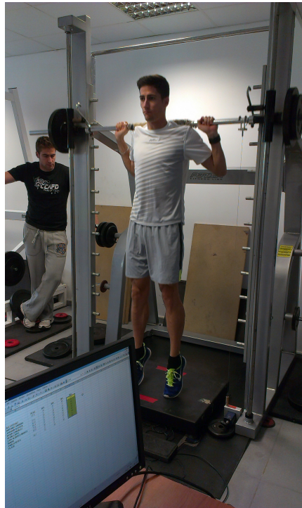
Figura 33. Imagen de la realización del test de flexión plantar utilizando la plataforma de fuerza Isonet (JLML, España) en una máquina tipo Smith Multipower (Murcia, España).
