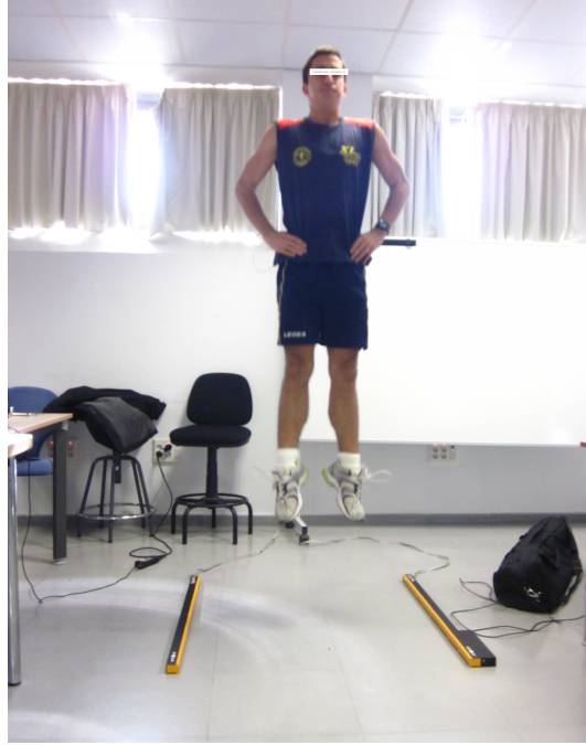
Figura 6. Imagen de la ejecución del test de salto CMJ con la plataforma de infrarrojos (Optojump, Microgate, Italia).
