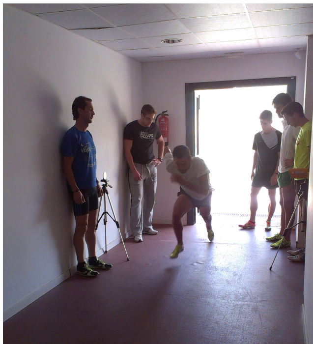
Figura 19. Imagen de la realización del test de 20 m en un recinto cubierto con las células fotoeléctricas (Polifemo Radio Light, Microgate, Italia).
