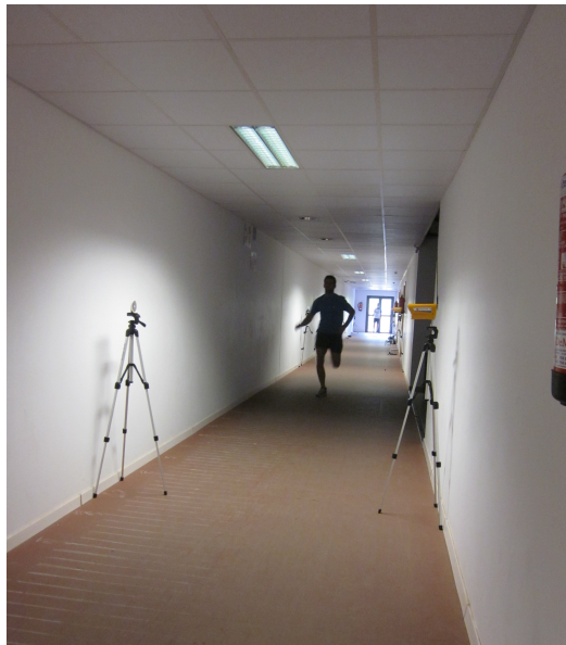
Figura 9. Imagen de la realización del test de velocidad de 40 m y tiempos parciales con las células fotoeléctricas (Polifemo Radio Light, Microgate, Italia).
