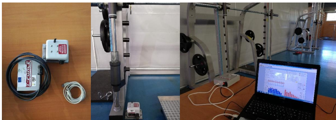
Figura 5. Dispositivo T-Force System para medir la velocidad a la que se desplaza la carga en todas las sesiones de evaluación y entrenamiento.
