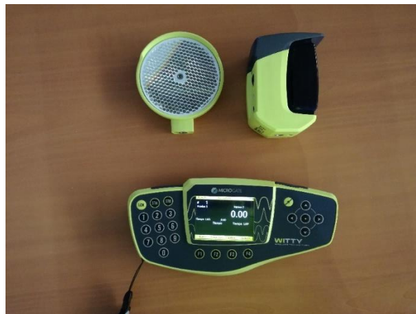
Figura 7. Células fotoeléctricas Microgate para medir el tiempo en el test de aceleración.
