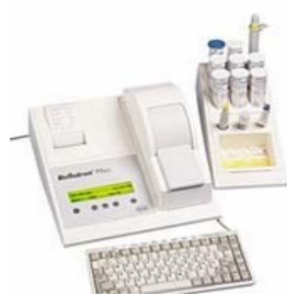
Figura 7. Imagen del medidor utilizado para la medición de la concentración de ácido úrico en sangre (Reflotrom, Boehringer Mannheim).
