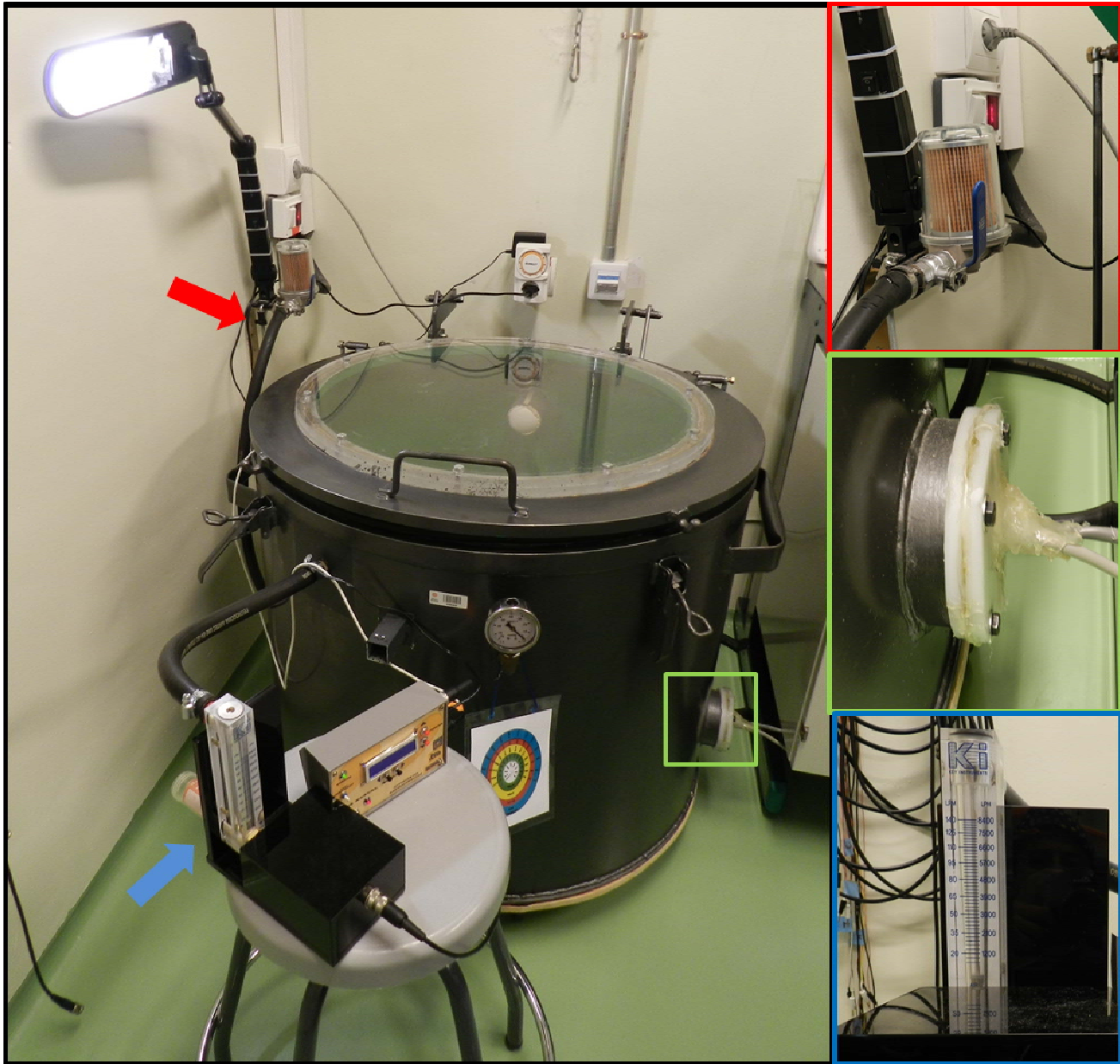
Figura 3.1. Imagen general y detalles de los accesorios de la cámara hipobárica. Nótese la salida (flecha y recuadro rojos) y la entrada (flecha azul) de la circulación de aire. La extracción del aire es forzada mediante una bomba de vacío (SB-10, DVP, Bolonia, Italia) situada en el exterior del edificio. Posee además una pequeña compuerta estanca intercambiable para entrada y salida del cableado (recuadro verde), necesarios para conectar los equipos externos con los electrodos implantados en los ratones durante las pruebas de electrofisiología, o con la jaula de Skinner durante el desarrollo del condicionamiento operante. El rotámetro se muestra en detalle (recuadro azul).
