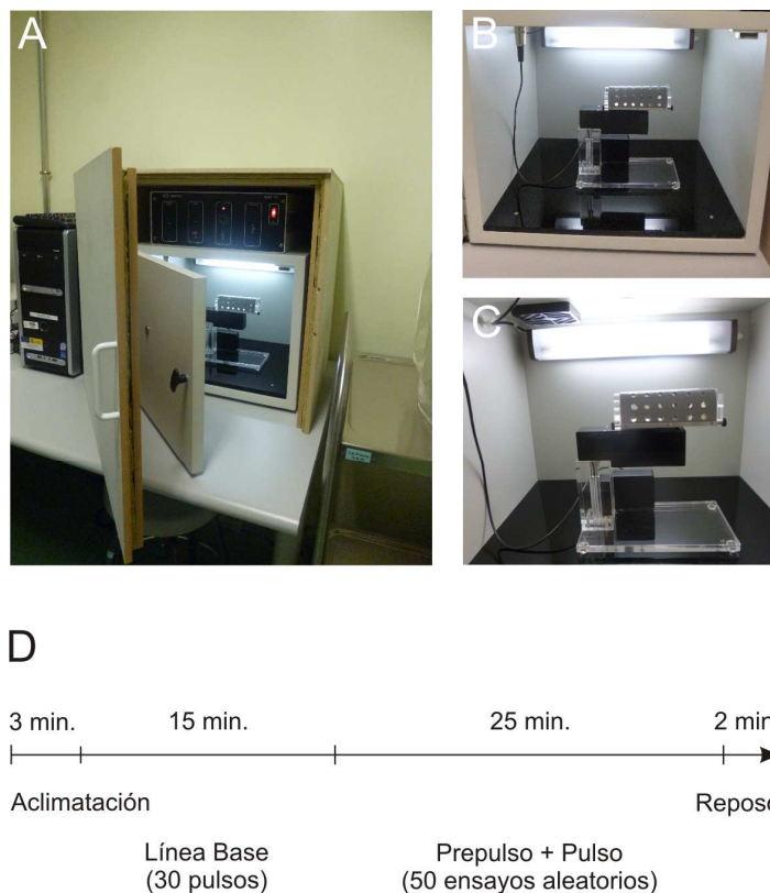
Figura 2.6. Inhibición por Prepulso. Medida del reflejo de sobresalto acústico en la cámara cerrada. (A) Representación general del aparato de la inhibición por prepulso. Nótese como la cámara esta colocada dentro de un armario, aislándolo así del ruido exterior. (B) y (C) Imágenes de la cámara con detalles de la cabina donde se aloja el ratón y el sensor. (D) Descripción de los pasos seguidos para la realización de la prueba. Cada sesión duró un total de 45 min., de los cuales los 3 primeros fueron de adaptación a la cámara. A continuación, se administraron 30 pulsos (125 dB, 100 ms), para calcular la línea base. 30 s después, el animal recibió 50 ensayos aleatorios, de los cuales 25 fueron pulsos aislados (125 dB, 100 ms) y otros 25 fueron pares de pulsos, esto es, con el pulso ya indicado (125 dB, 100 ms) precedido de otro de menor intensidad y duración (85 dB, 50 ms) para calcular la inhibición por prepulso. Todos los estímulos se separaron con un intervalo de aproximadamente 30 s. La sesión finalizó con 2 min. de reposo.
