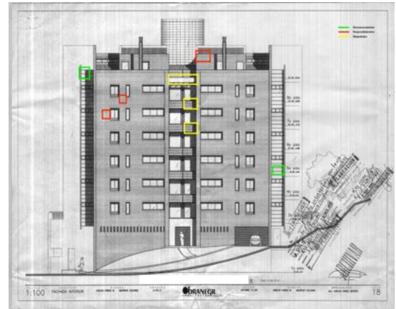
Ilustración 37. Levantamiento patológico edificio A.
