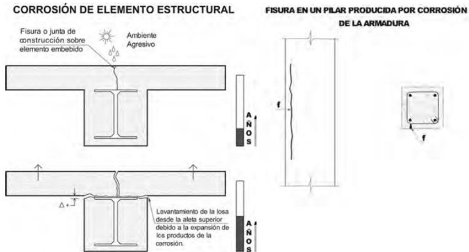
Ilustración 2. Patología por corrosión. Tomada de Guía de patologías constructivas (2011).
