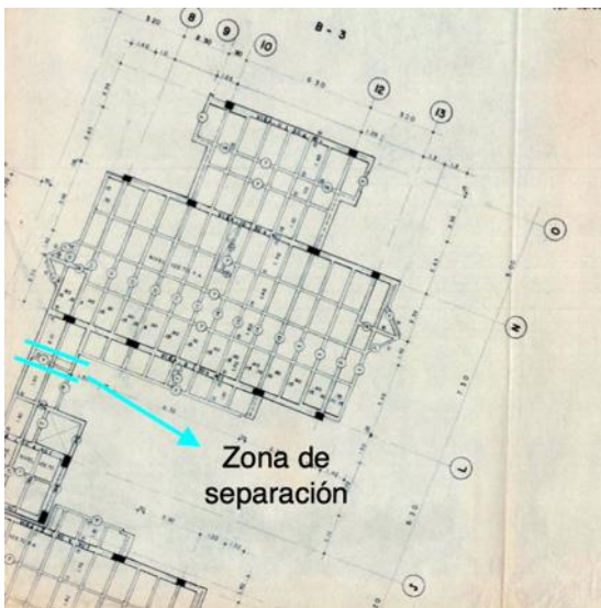
Ilustración 60. Zona de separación entre bloques.
