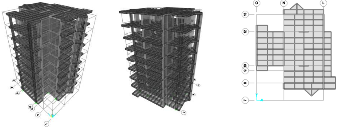
Ilustración 62. Modelo en SAP2000 de la intervención propuesta.
