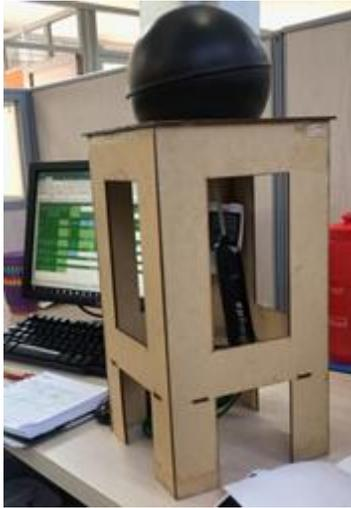
*Ilustración 12 Termómetro de globo (realización propia)*
