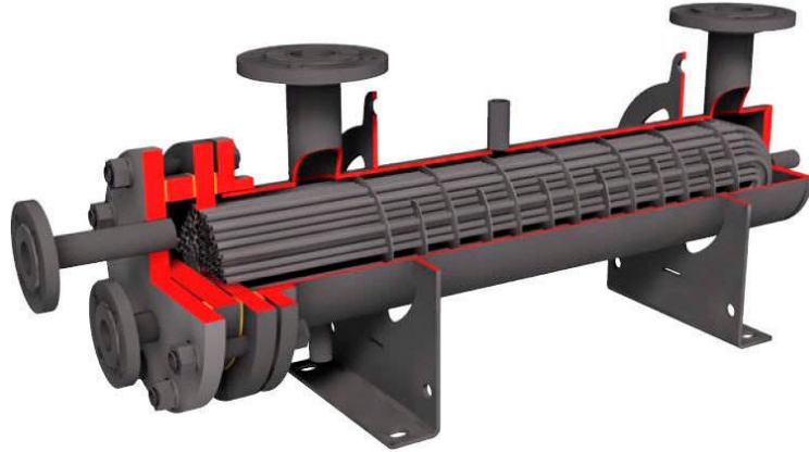
Ilustración 1. Intercambiador de calor de coraza y tubos. (nauticexpo, n.d.)
