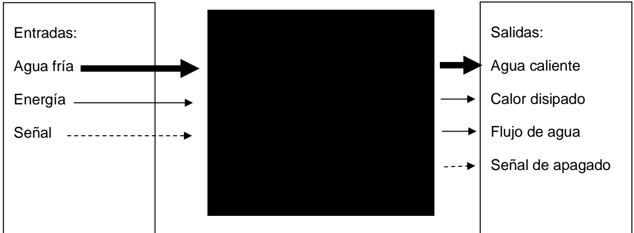
Ilustración 17. Caja negra Colector solar
