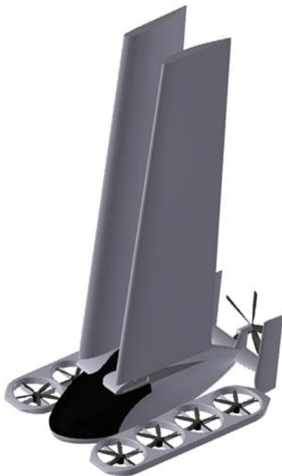
Ilustración 33. Modelo CAD del concepto en etapa de despegue y aterrizaje
