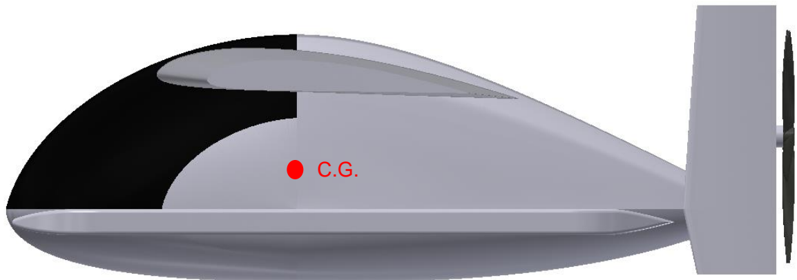
Ilustración 28. Perfil del modelo CAD final con C.G. supuesto
