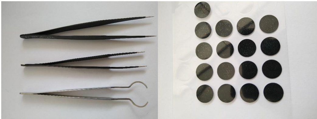
Figura 25. Implementos necesarios para el montaje de muestras (a) Pinzas (b) Almohadillas.
