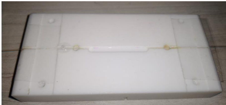
Figura 21. Fibra empalmada y posicionada sobre la celda de trabajo.
