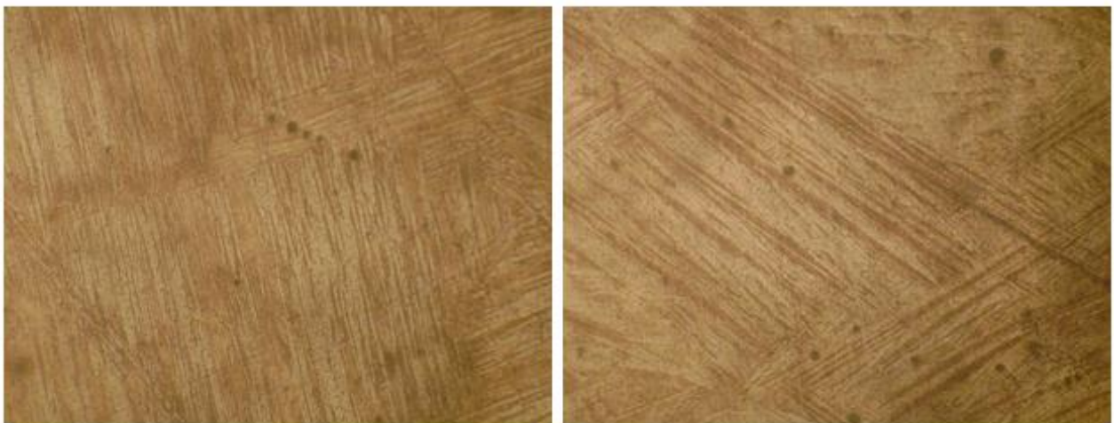
Figura 28. Metalografía luego del Temple 1, (3 y 5% de Fe). 500X. Fuente: Microscopio metalográfico del C.I.E.M.
