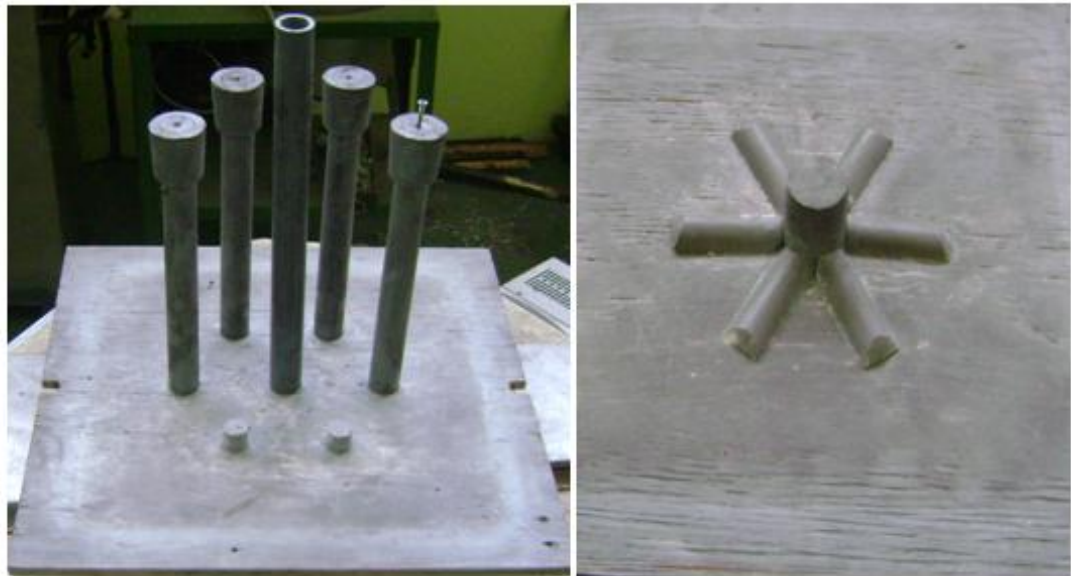
Figura 20. Modelo para molde de arena en verde.
