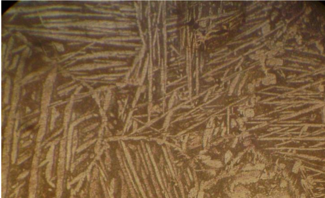
Figura 32. Metalografía luego del Revenido 1, a 600 °C, (3% Fe). 500X.
