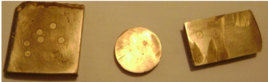
Figura 22. Muestras de la primera colada de bronce al aluminio.
