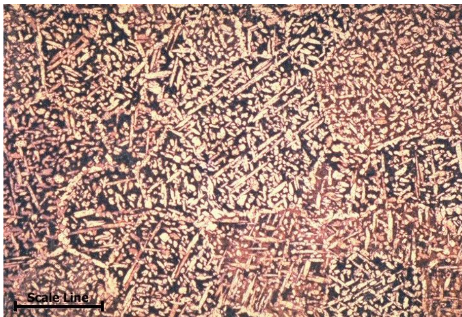
Figura 5. Metalografía del cuproaluminio C95400, recocido y templado. Longitud línea de escala 500 \mu\text{m} . Fuente: Copper Development Association, 2009.
