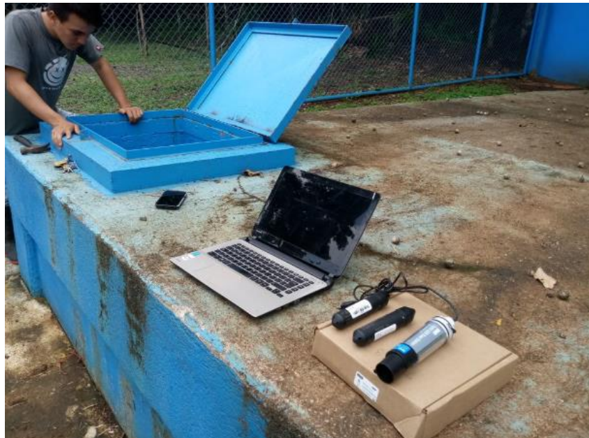
Figura 8. Prueba de niveles en tanque Maroto.
