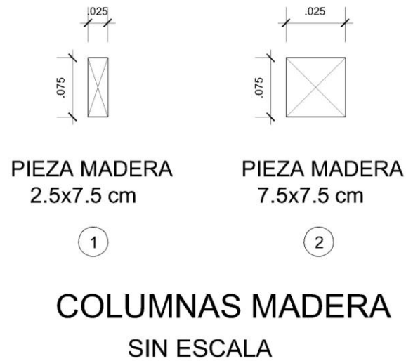
Imagen No 138. Detalle Columnas Madera.
