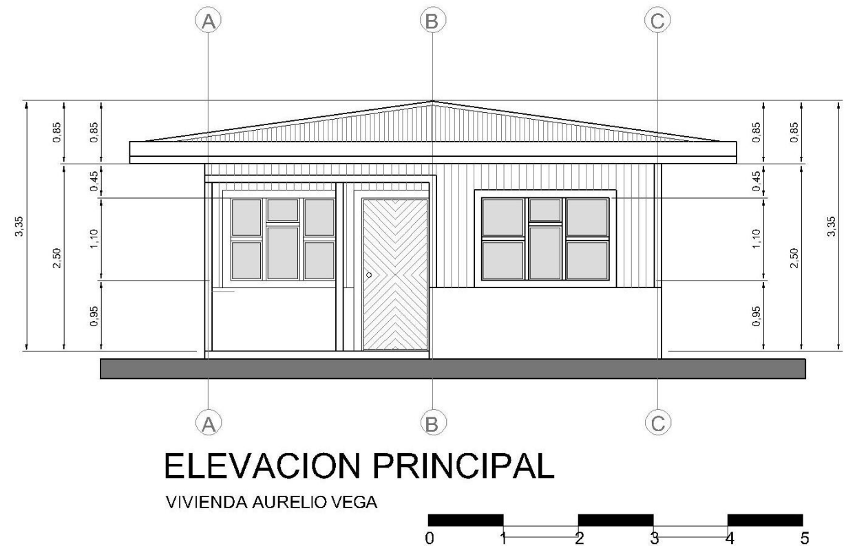
Imagen No 114. Vivienda Aurelio Vega . Cubierta de cuatro aguas.
