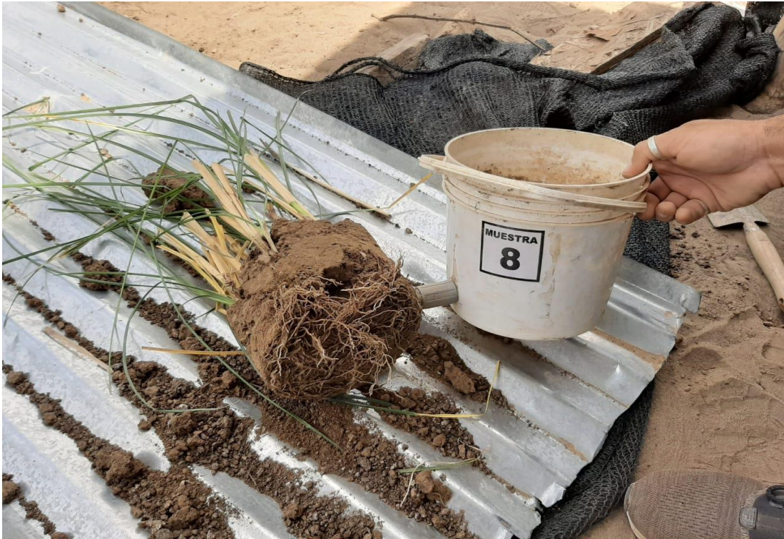
Figura 7. Desterronado del suelo contaminado para la extracción de muestras y análisis del plomo.
