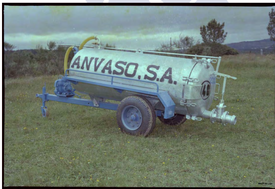
Imaxe 33. Cisterna de xurro con sistema de aspersión por tubo. Marca Anvaso S.A. Unha empresa con participación de DYPSA. 1976 479 .
