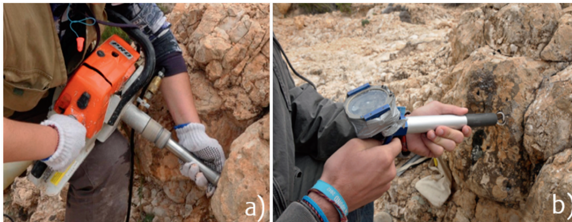
Figura 3.5. Ejemplo de toma de muestras llevada a cabo en Aín Bni Mathar, (Marruecos) realizada en muestras duras, mediante una perforadora a gasolina, a), y la posterior orientación de los ejemplares cilíndricos obtenidos, mediante el clinómetro, b). Fotos ©Claudia Álvarez Posada.
