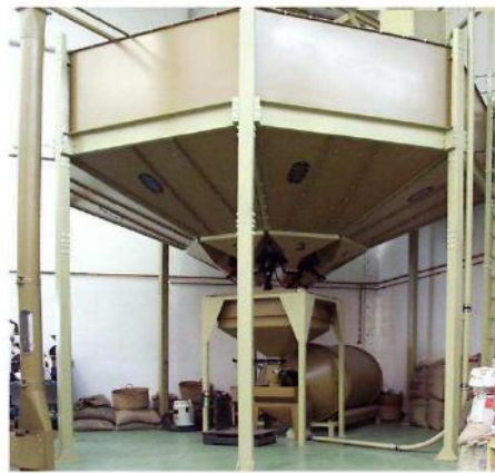
Figura 3: silo de almacenamiento
