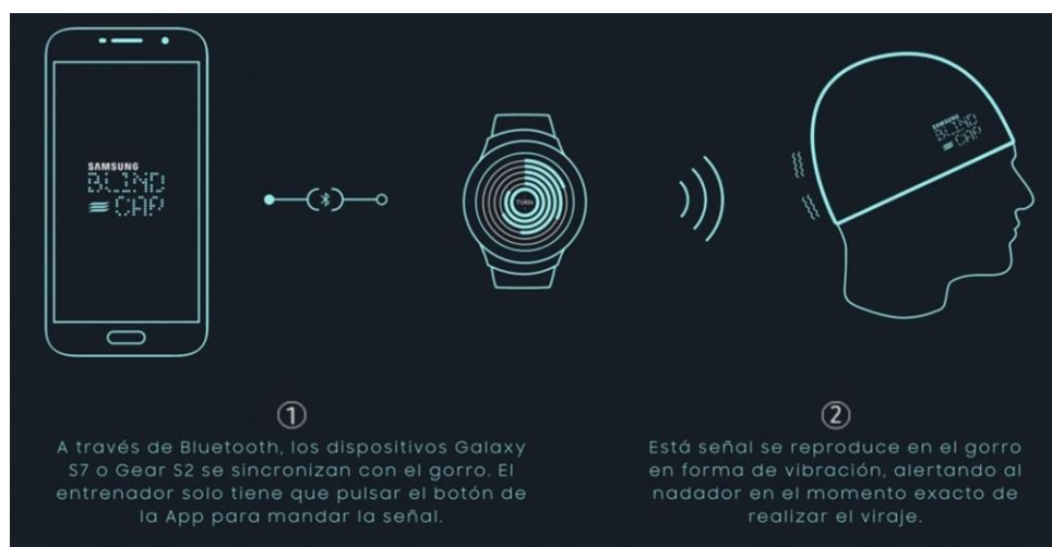
Fig.2. Esquema de conexión de Blind Cup ® [6] .
