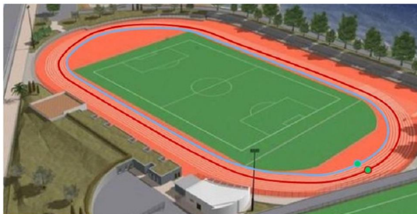
Fig.4. Esquema de diseño de la pista de atletismo para Blind Track®: Cada uno de los círculos concéntricos fijados sobre dos de las calles de la pista de atletismo marcados en rojo y azul tiene fijada una línea de corriente
