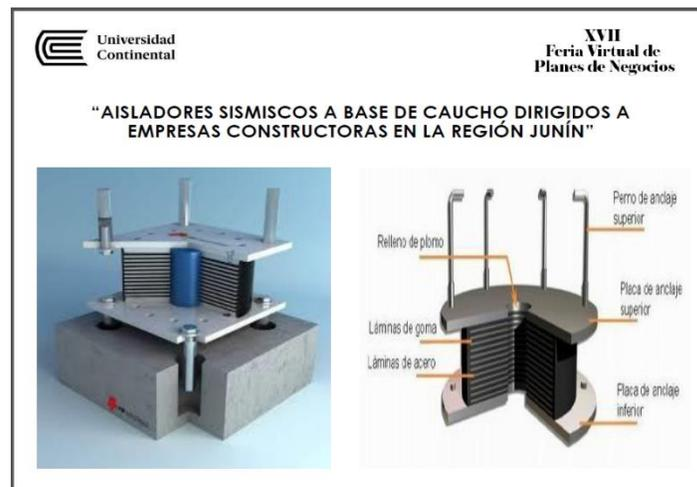
Figura 15. Aislador sísmico a base de caucho (2020). (s. f.). [Ilustración]. AislaSismic21. Tomada de <https://www.continental.edu.pe/emprendimiento/project/tecnologia-antisismica-base-de-caucho-dirigidos-empresas-constructoras-en-la-region-junin/aislasismic21/>
