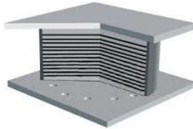
Figura 7. Aislador sísmico de alto amortiguamiento (2020). (s. f.). [Ilustración]. Tomada de <https://repository.usta.edu.co/bitstream/handle/11634/19088/2019luzaficano1.pdf?sequence=1&isAllowed=y>.
