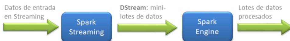
Figura 4.6: Funcionamiento de Spark Streaming.
